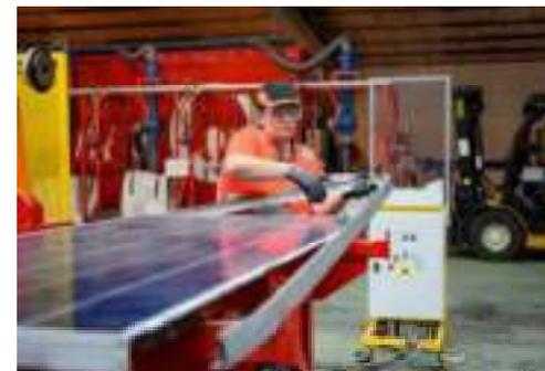
Figure 27 : Démontage du cadre en aluminium d'un panneau solaire (Source : Soren)
