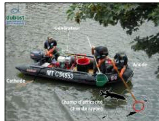
Figure 93 : Illustration du principe de pêche à l'électricité avec un appareil fixe depuis un bateau
