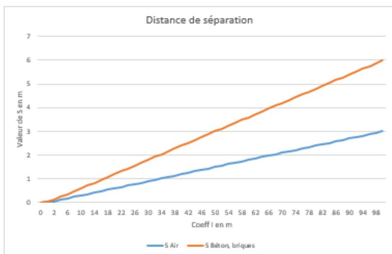
**NOTA:** La distance de séparation est la distance minimale pour laquelle il n'y a pas formation d'étincelle dangereuse entre un conducteur de descente écoulant le courant de foudre et une masse conductrice voisine liée la terre. Pour qu'il y ait isolement au sens des étincelles dangereuses, il faut que la distance d séparant le système de protection contre la foudre de l'élément conducteur considéré, soit supérieur à s.
