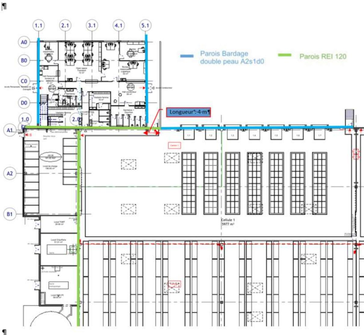
Figure 4 : Traitement coupe-feu de la façade des bureaux et de la cellule 1
