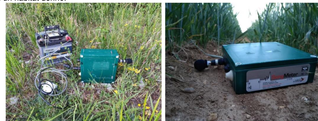
Figure 145 : Installation du dispositif d'écoute en continu (SM2Bat) (photographies prises hors site) (source : ENVOL Environnement, 2020)
