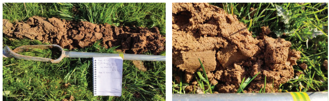
A l'image de la grande majorité des sondages réalisés sur la zone d'implantation potentielle, les sondages n°5 et 6, constitués de sable limoneux, ne présentent pas ou très peu de traces d'oxydoréduction.
