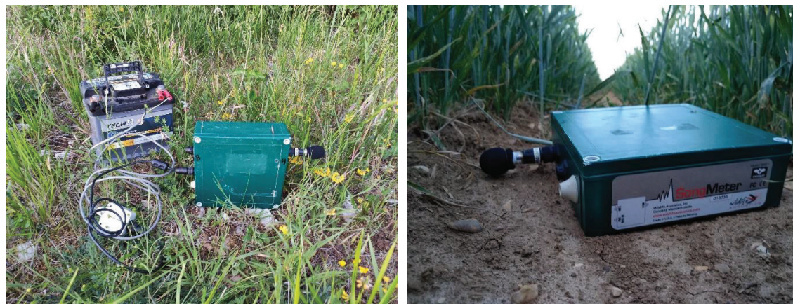
Installation du dispositif d'écoute en continu (SM2Bat) (photographies prises hors site) Source : ENVOL ENVIRONNEMENT
