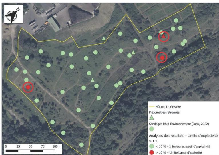
Figure 7 : Cartographie des résultats de LEL dans les gaz du sol – couche 0-1 m (t/n)
