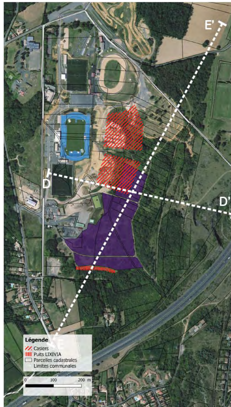
Figure 99 - Localisation des coupes et zonage des casiers et puits LiXIVIA sur la zone de projet
