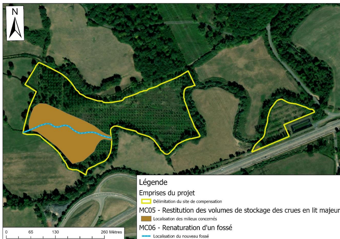
Figure 10 : Surface concernée par les travaux de restauration du volume de crue et localisation du fossé - © Ecosphère
